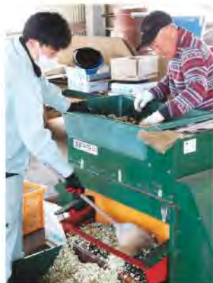
花蕾を採薬機に入れ薬を取り出していきます
